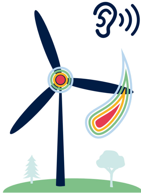
Figur 26 Illustration av var ljud uppstår vid ett vindkraftverk i drift.
