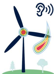
Figur 18. Illustration av var ljud uppstår vid ett vindkraftverk i drift.
